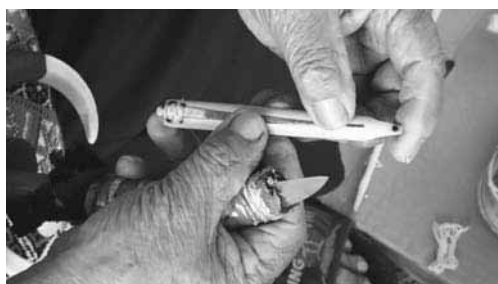
圖24：測量簧片長度並裁切
